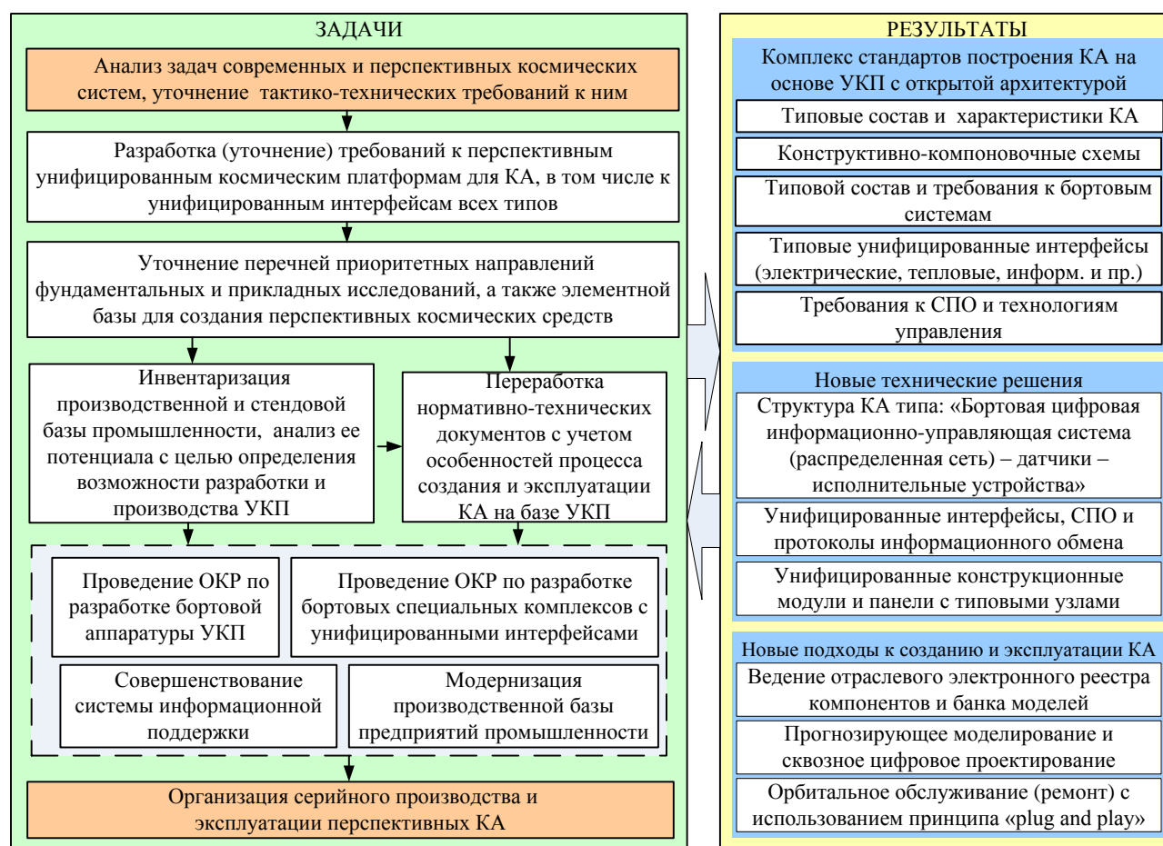
Рис. 1. Концепция внедрения стандартизованной открытой архитектуры унифицированных космических платформ при создании перспективных космических аппаратов
