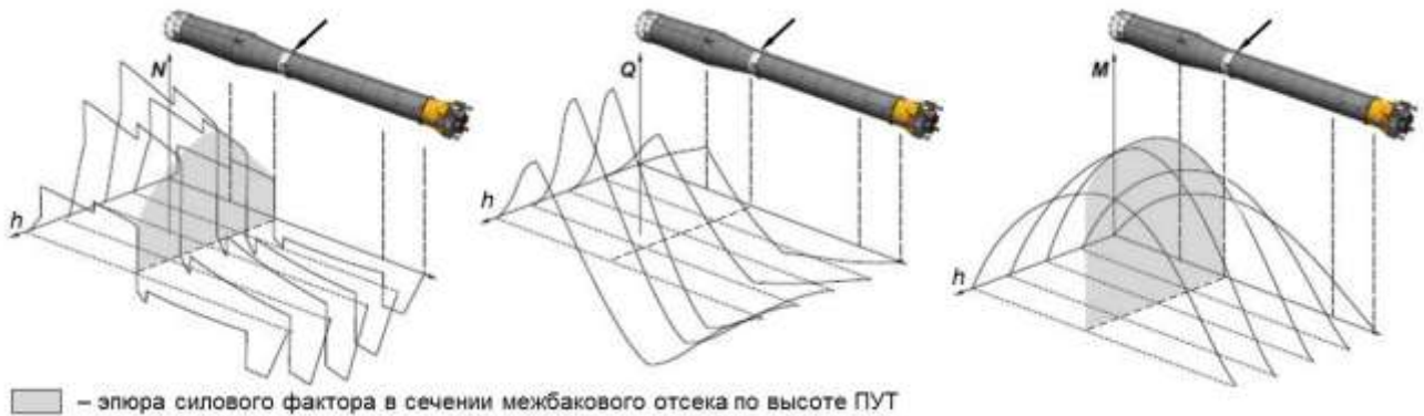
Рис. 2. Характер распределения внутренних силовых факторов N , Q и M по длине корпуса блока «А» РН типа «Союз» и высоте пассивного участка траектории
